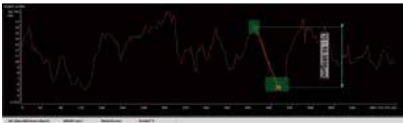
扩散板 / 剖面测量 (MPLAPON50XLEXT / 3x3 拼接)
