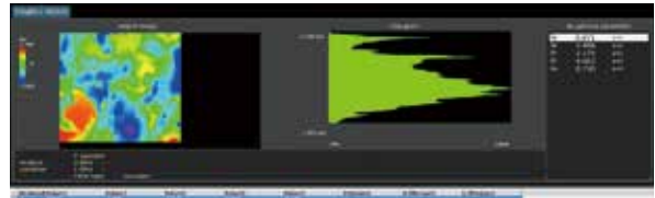
铜板 / 面粗糙度测量 (MPLAPON50XLEXT)
