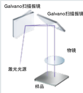
传统的激光显微镜（近端 Galvano 结构）
